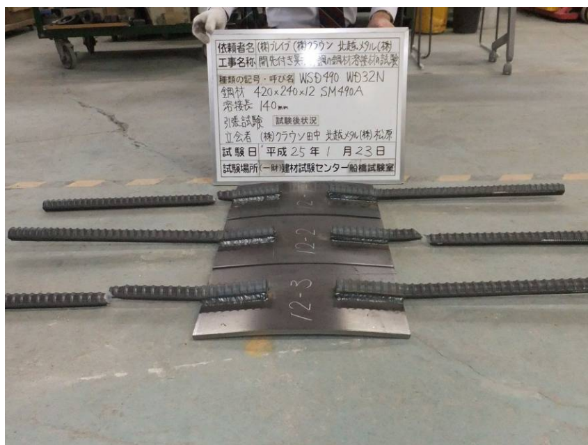
写真11. 鋼材(SM490A)にWSD490 WD32Nを溶接した溶接部の引張試験体(破断状況)
