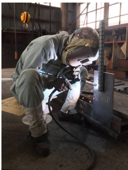
写真1. WSD490 試験体製作状況(立向き溶接)
