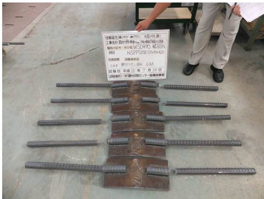
写真7. 鋼材(NSPP520B)に WSD490 WD38N を溶接した溶接部の引張試験体(破断状況)
