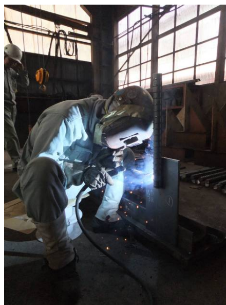
写真1. WSD490 試験体製作状況(立向き溶接)
