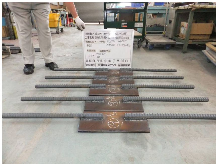
写真4. 鋼材(NSPP520B)にWSD490 WD32Nを溶接した溶接部の引張試験体
