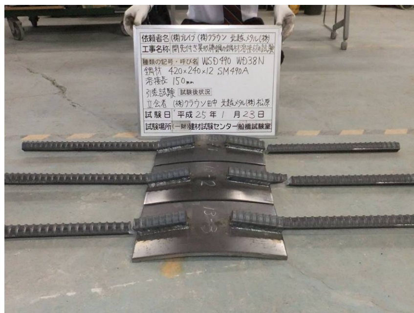
写真13. 鋼材(SM490A)にWSD490 WD38Nを溶接した溶接部の引張試験体(破断状況)
