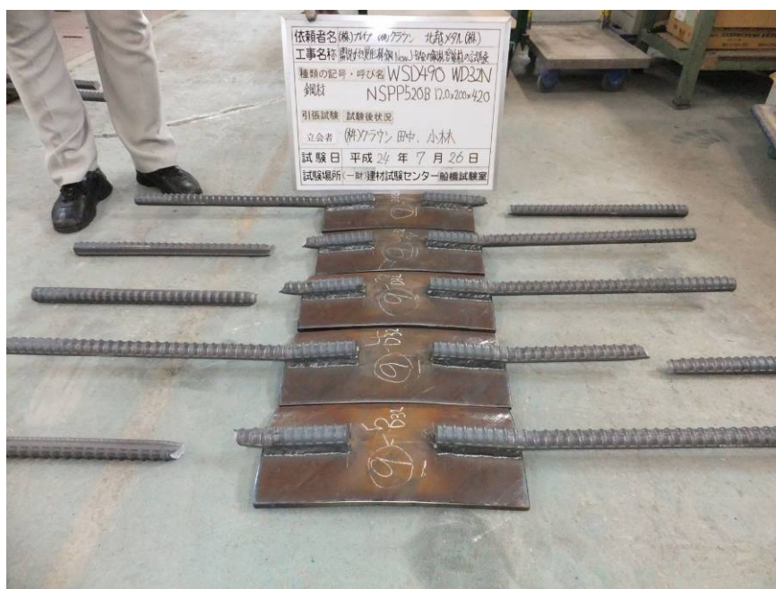
写真5. 鋼材(NSPP520B)にWSD490 WD32Nを溶接した溶接部の引張試験体(破断状況)
