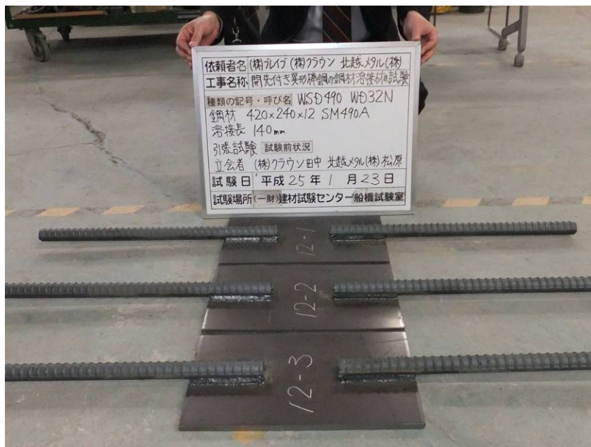
写真10. 鋼材(SM490A)にWSD490 WD32Nを溶接した溶接部の引張試験体
