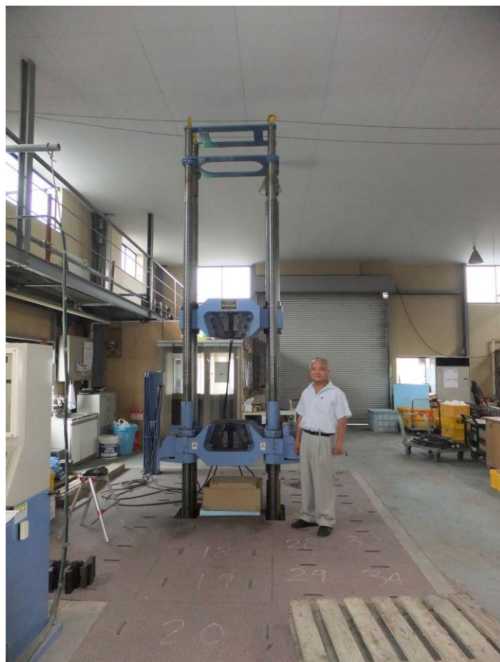
写真14. 鋼材に開先付き異形棒鋼を溶接した溶接部の引張試験状況
