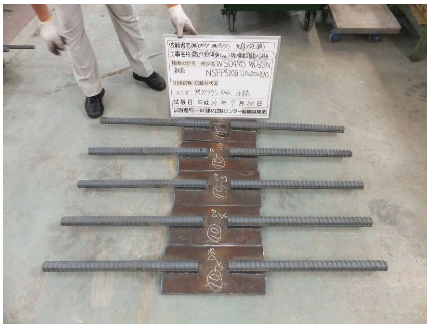
写真6. 鋼材(NSPP520B)に WSD490 WD38N を溶接した溶接部の引張試験体
