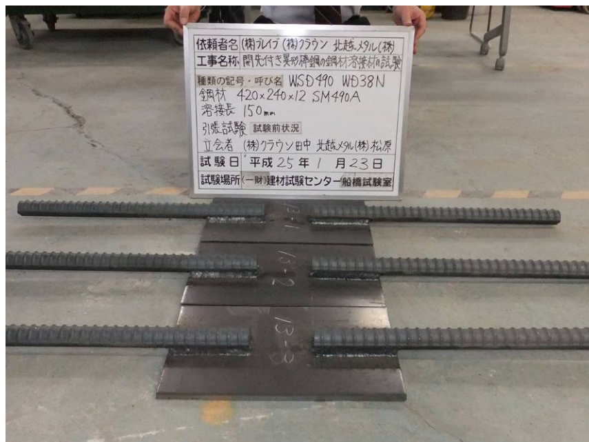
写真12. 鋼材(SM490A)にWSD490 WD38Nを溶接した溶接部の引張試験体
