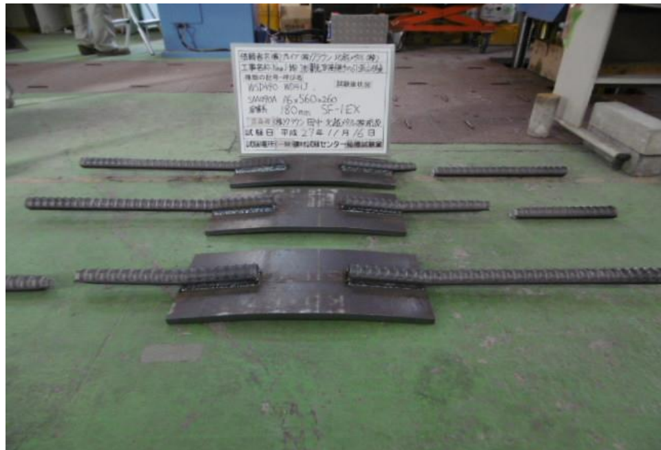
写真6 WSD490・WD41J SM490A 溶接引張試験 破断状況
