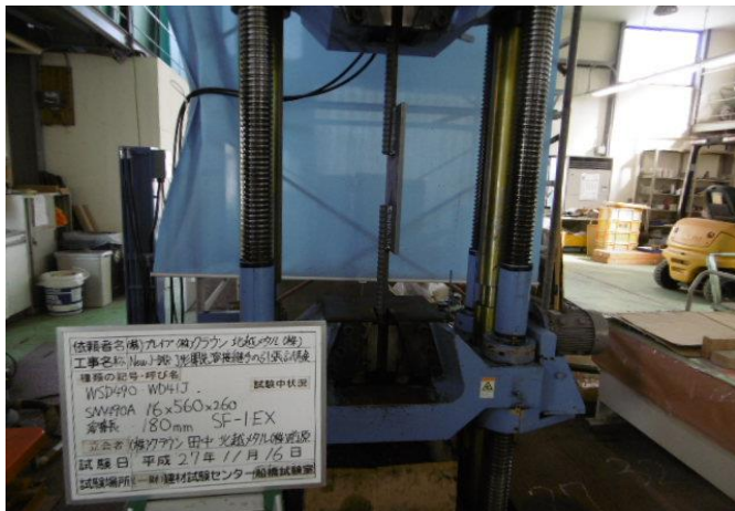
写真3 WSD490・WD41J SM490A 溶接引張試験 試験体1
