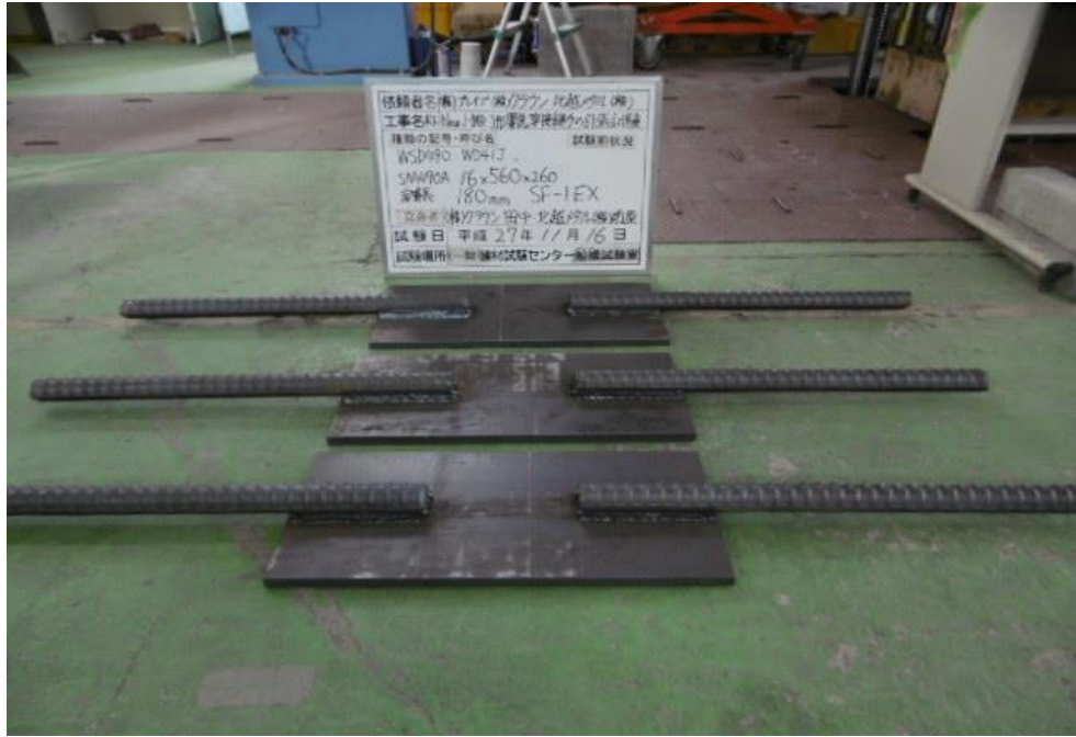
写真2 WSD490・WD41J SM490A 溶接引張試験 試験前
