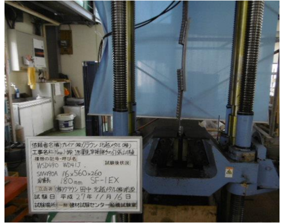
SM490A 溶接引張試験 試験体2
