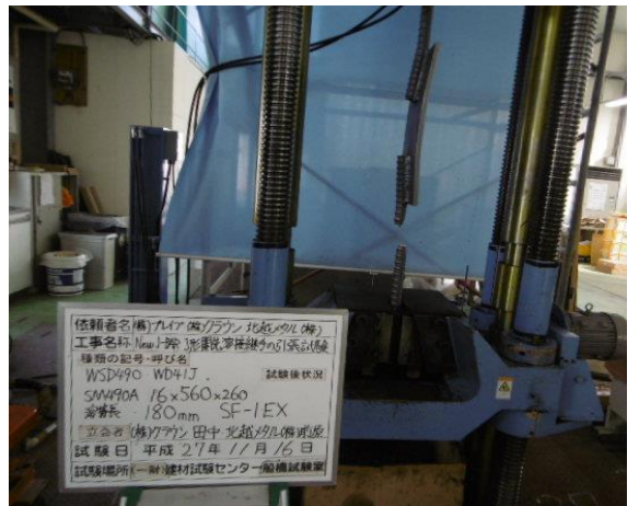
写真3 WSD490・WD41J SM490A 溶接引張試験 試験体1
