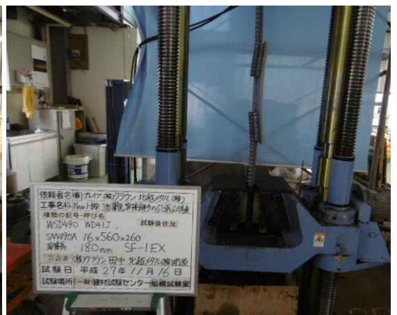
SM490A 溶接引張試験 試験体3
