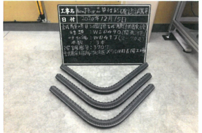
写真1. WD41Jの引張試験後及び曲げ試験後の状況写真
