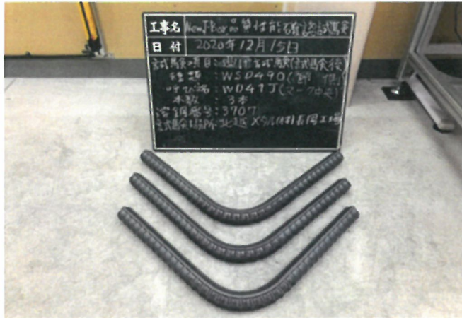
写真1. WD41Jの引張試験後及び曲げ試験後の状況写真
