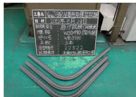
写真1.WD38Nの引張試験後及び曲げ試験後の状況写真
