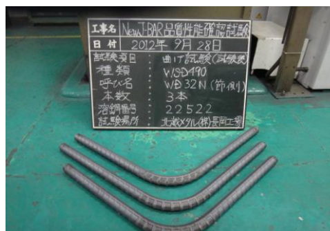
写真1.WD32Nの引張試験後及び曲げ試験後の状況写真
