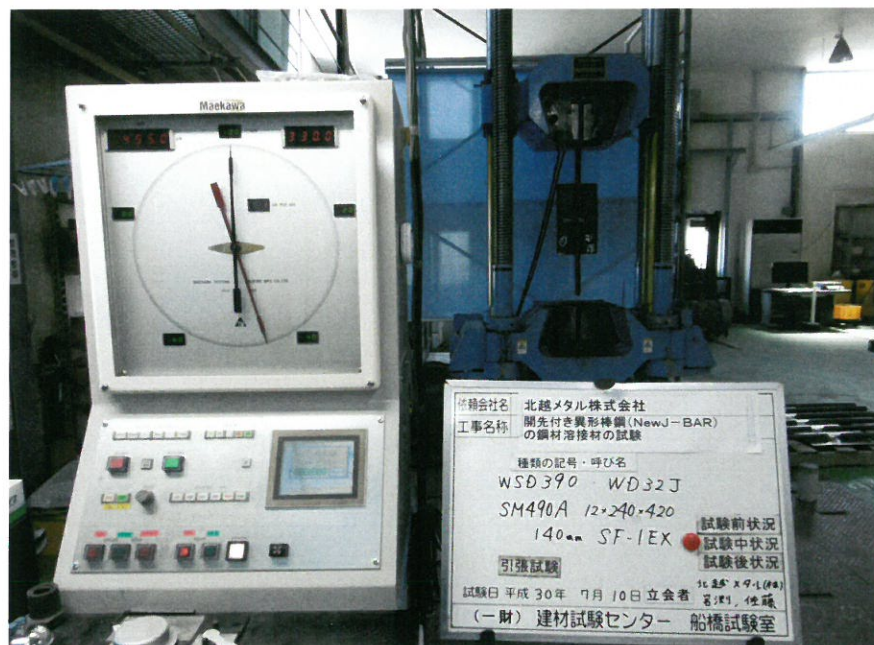
写真-2 試験中の状況 (WD 3 2 J)
