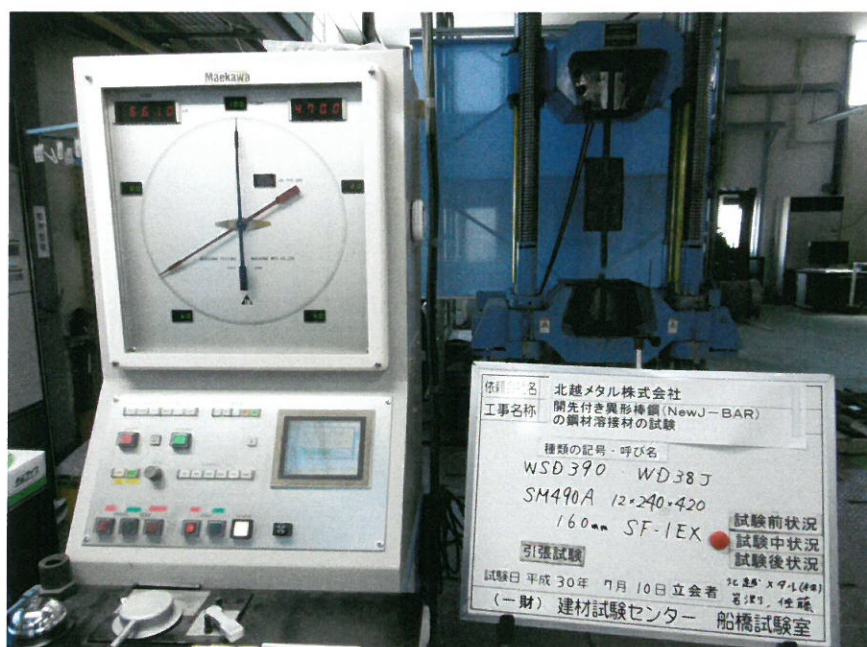
写真－8 試験中の状況 (WD 38 J)
