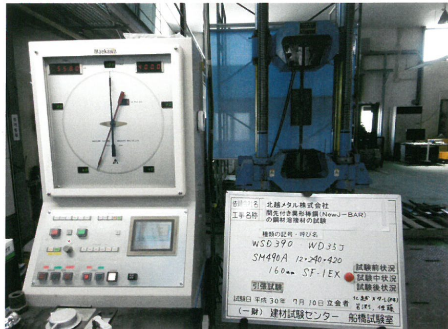
写真-5 試験中の状況 (WD35J)
