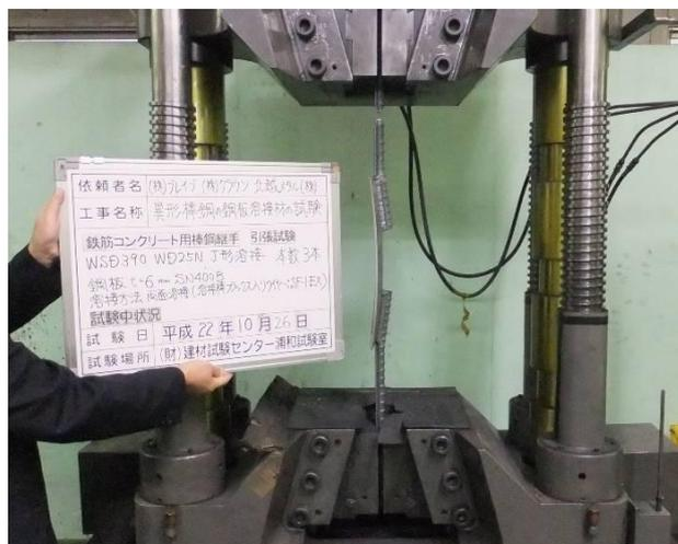
写真2. 鋼材(SN400B)にWD25Nを溶接した溶接部の引張試験状況
