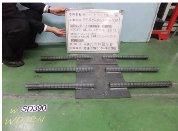
写真7. 鋼材(SN490B)にWD38Nを溶接した溶接部の引張試験体
