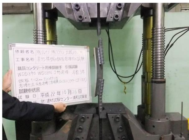
写真8. 鋼材(SN490B)にWD38Nを溶接した溶接部の引張試験状況
