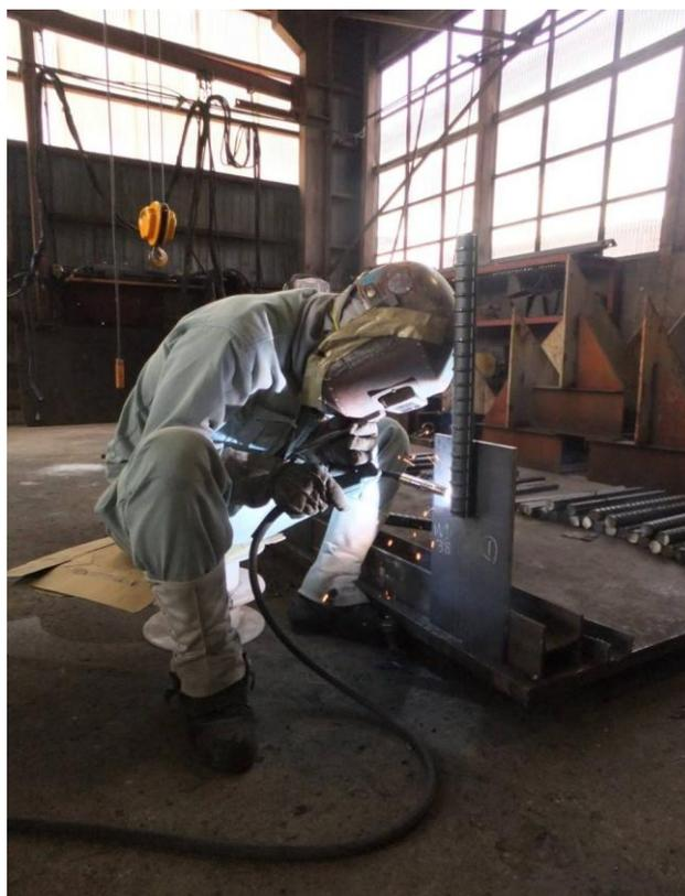
写真1. NewJ-BAR溶接施工状況
