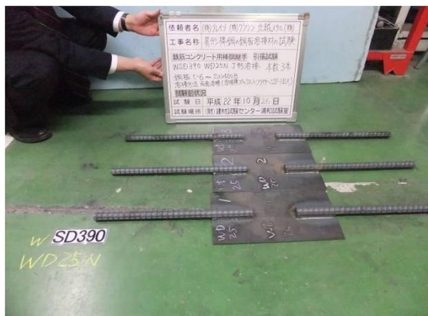
写真1. 鋼材(SN400B)にWD25Nを溶接した溶接部の引張試験体
