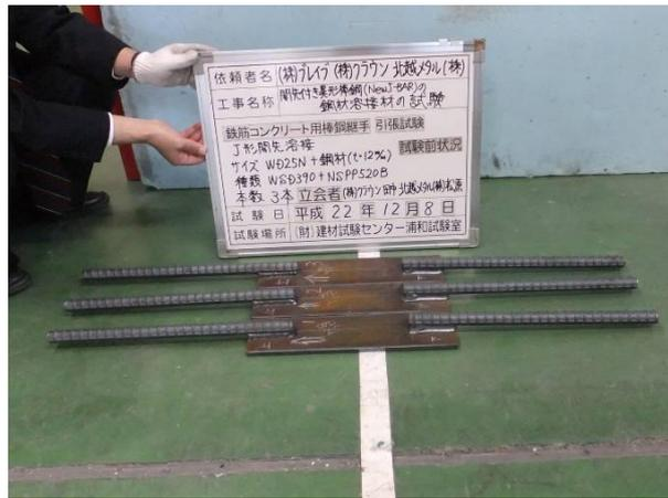
写真10. 鋼材(NSPP520B)にWD38Nを溶接した溶接部の引張試験体
