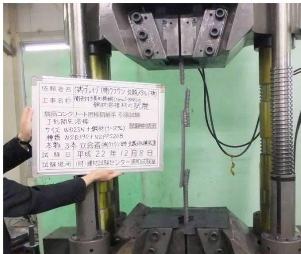
写真5. 鋼材(NSPP520B)にWD25Nを溶接した溶接部の引張試験状況
