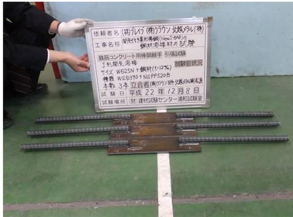
写真4. 鋼材(NSPP520B)にWD25Nを溶接した溶接部の引張試験体
