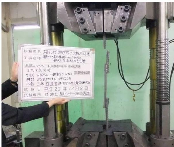
写真11. 鋼材(NSPP520B)にWD38Nを溶接した溶接部の引張試験状況
