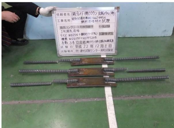
写真12. 鋼材(NSPP520B)にWD38Nを溶接した溶接部引張試験 破断状況
