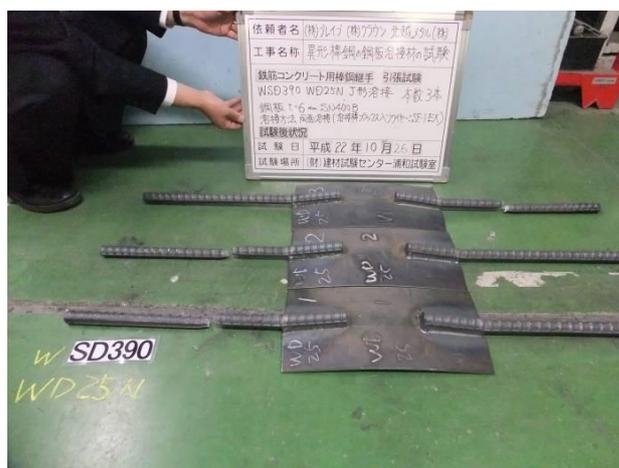
写真3. 鋼材(SN400B)にWD25Nを溶接した溶接部引張試験 破断状況
