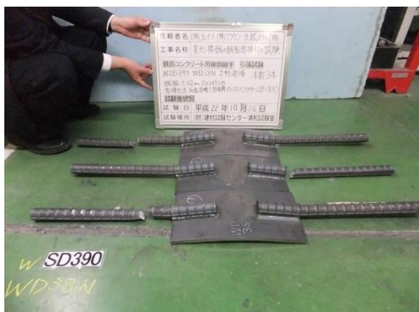
写真9. 鋼材(SN490B)にWD38Nを溶接した溶接部引張試験 破断状況
