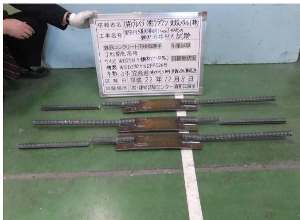
写真6. 鋼材(NSPP520B)にWD25Nを溶接した溶接部引張試験 破断状況
