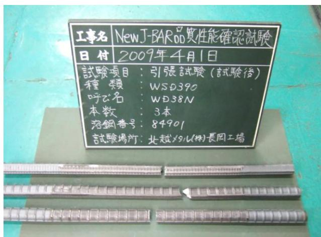
写真1.引張試験後の状況
