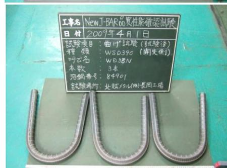
写真2.曲げ試験後の状況(180° 曲げ)
