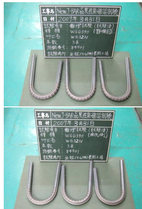
写真2. 曲げ試験後の状況(180° 曲げ)
