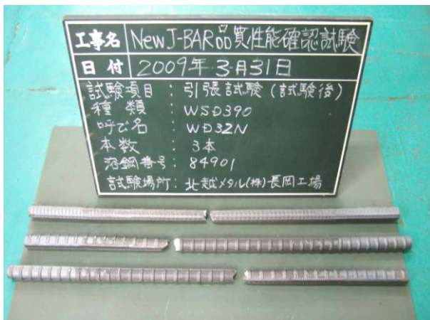
写真1. 引張試験後の状況
