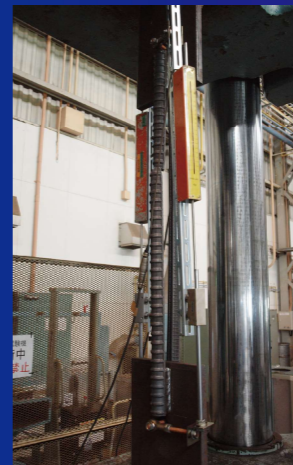
溶接部引張試験状況(WSD490、780N/mm 2 級鋼材)
