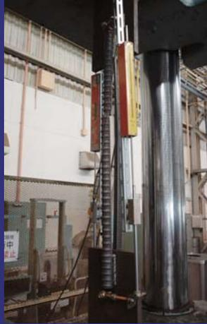
溶接部引張試験状況
